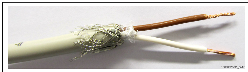
插图 7-7： 屏蔽编织层，电线顶部
