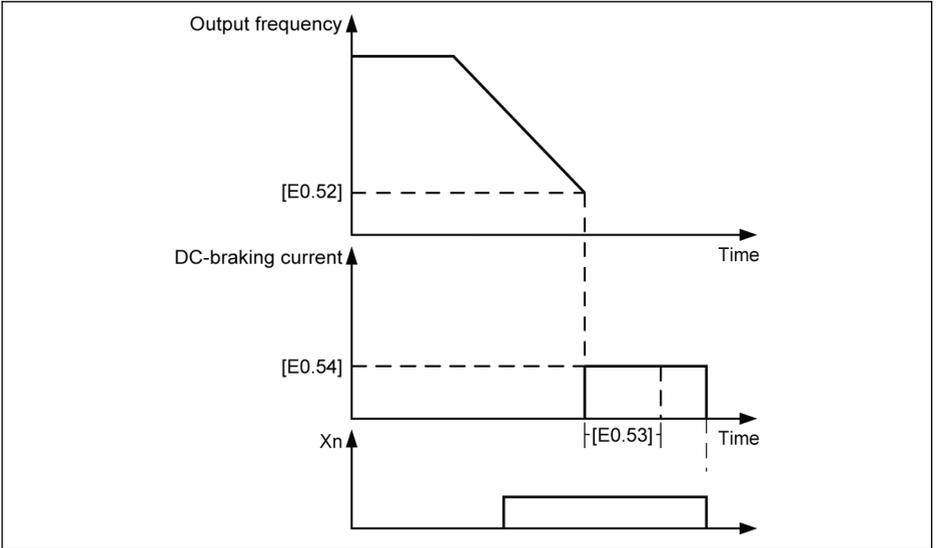
插图 12-65: 停机直流制动\_4
