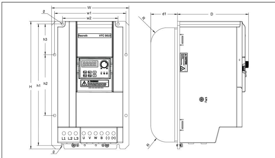
插图 7-10: VFC 5610 22K0 外型图(穿墙式机型)
