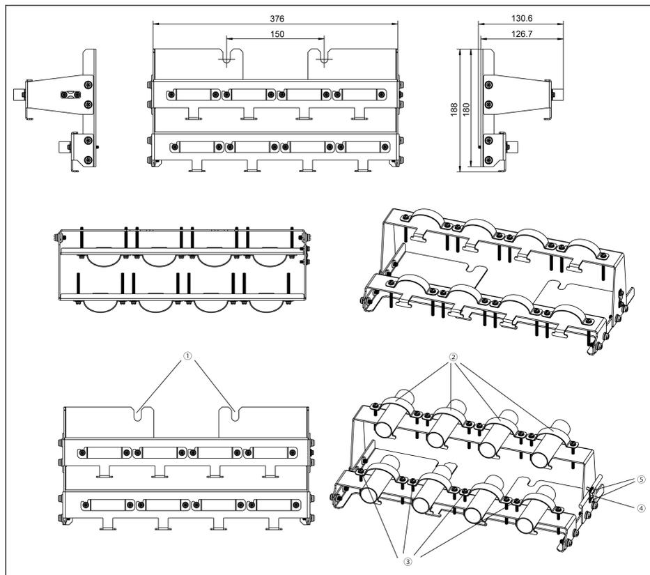
插图 14-43: 110K...132K 屏蔽电缆连接附件
