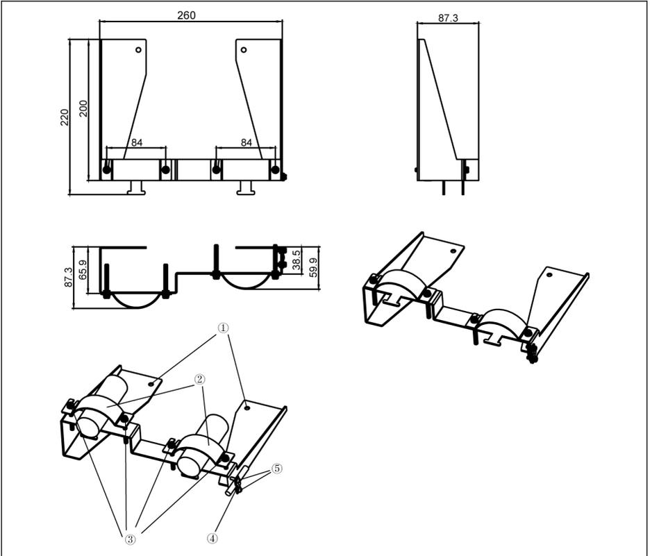
**插图 14-42:** 45K0...90K0 屏蔽电缆连接附件
