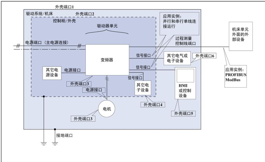
插图 9-1: 驱动系统抗干扰度要求的含义
