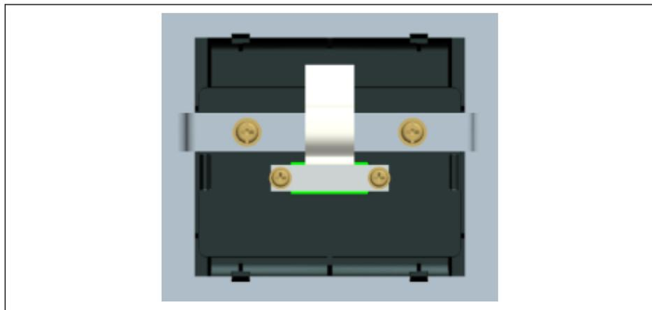
插图 14-5: 电缆连接与固定
