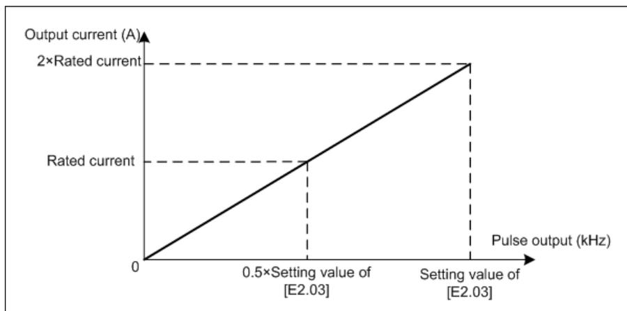
插图 12-86: 变频器输出电流
