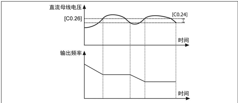
插图 12-15: 减速过程失速过电压防止
