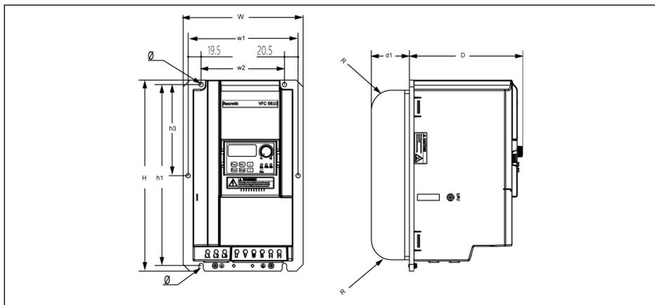
插图 7-9: VFC 5610 15K0 外型图(穿墙式机型)
