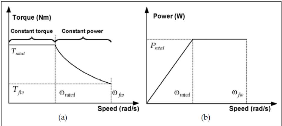
插图 12-41: 转矩特性和功率速度曲线
