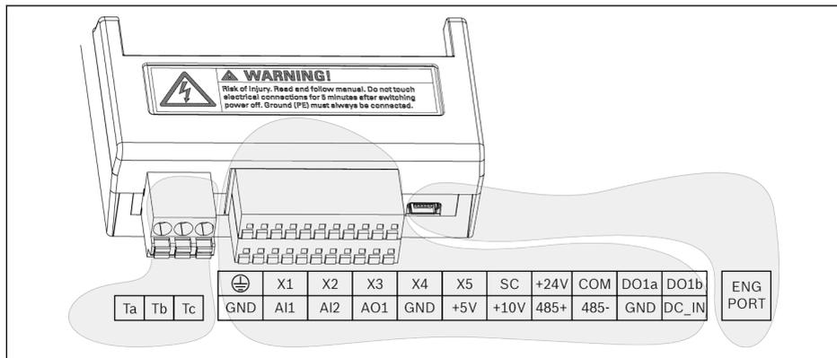
插图 8-10: 控制回路端子图
