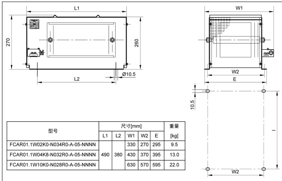
插图 14-37: 制动电阻尺寸\_4
