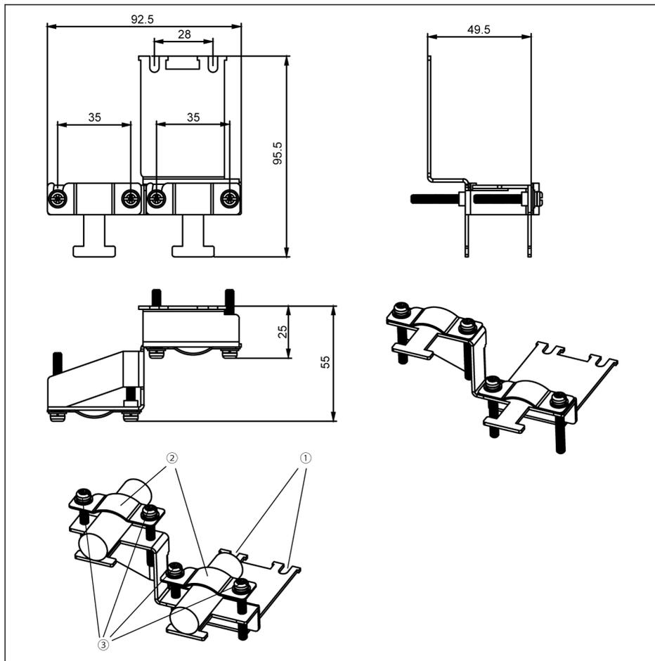
插图 14-40: 5K50...22K0 屏蔽电缆连接附件
