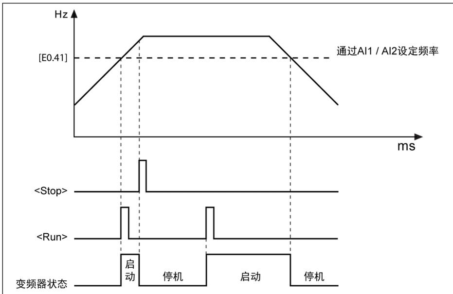
插图 12-61: 根据设定频率自动启动/停机
