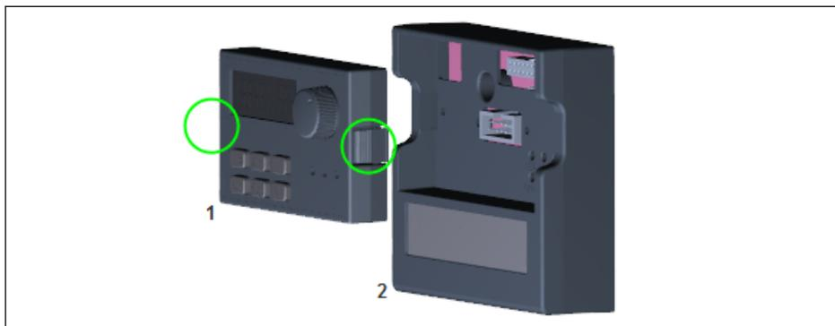
插图 15-2: 操作面板的拆卸
