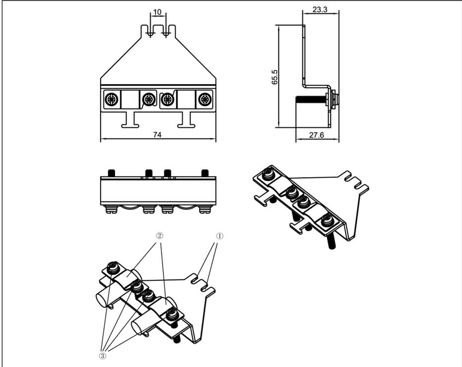
插图 14-39: OK40...4K00 屏蔽电缆连接附件
