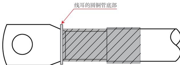
插图 8-3: 主回路电缆端子防护
