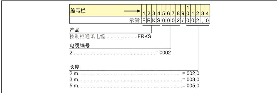
插图 18-4: 控制柜通讯电缆类型编码
