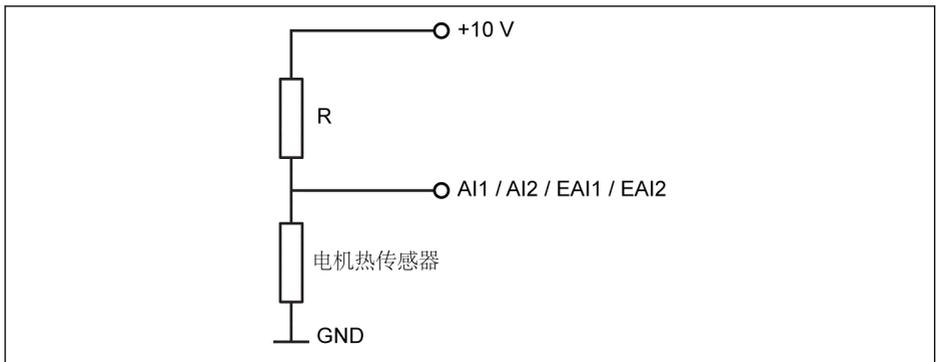
插图 12-28: 使用电压源的温度传感器
