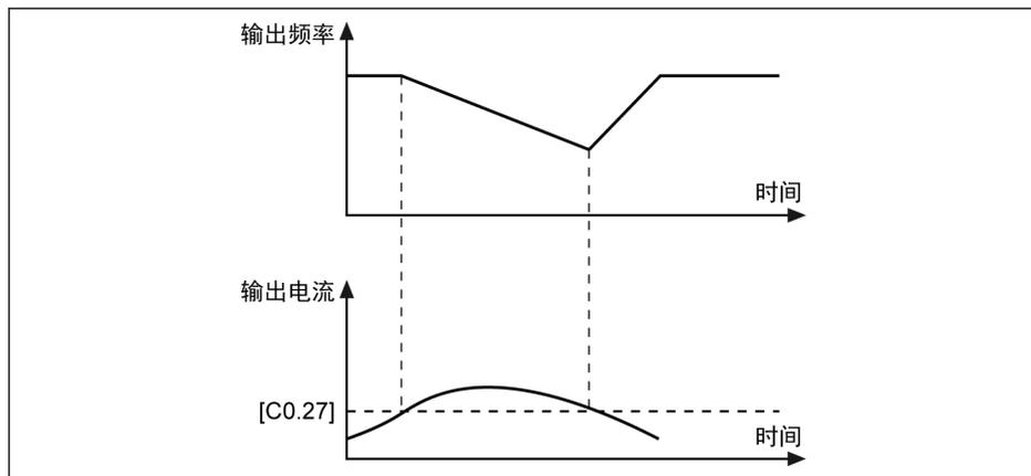
插图 12-17: 恒速中失速过电流
