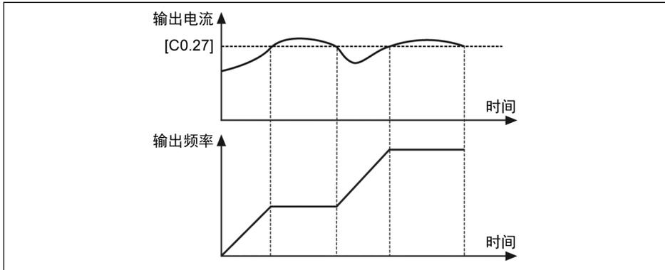
插图 12-16: 加速中失速过电流
