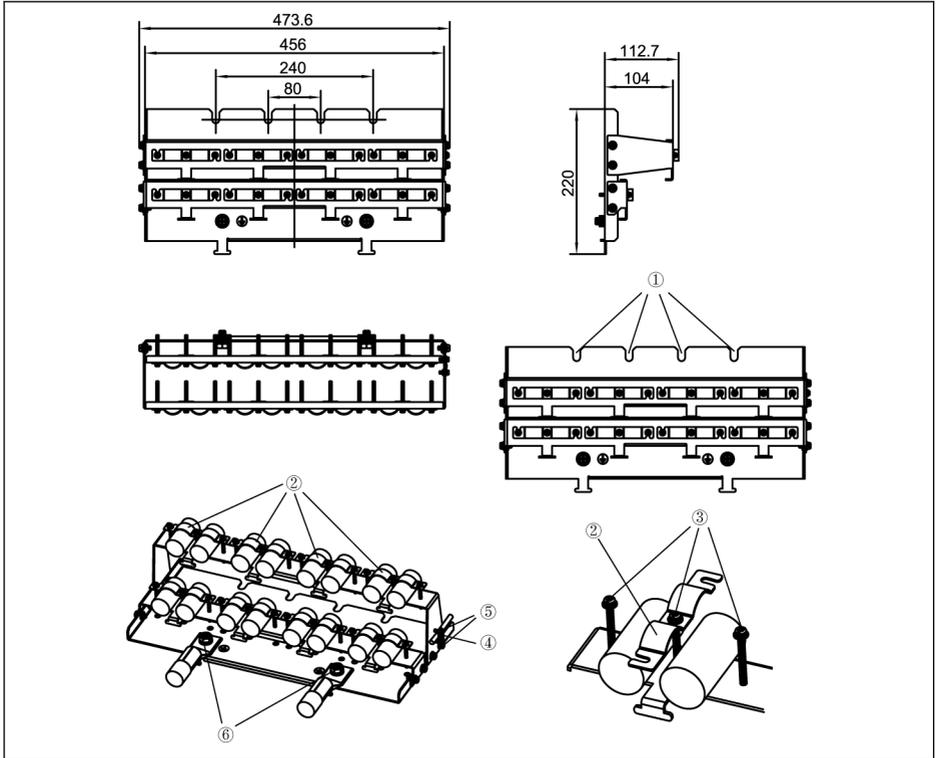
插图 14-44: 160K...185K 屏蔽电缆连接附件
