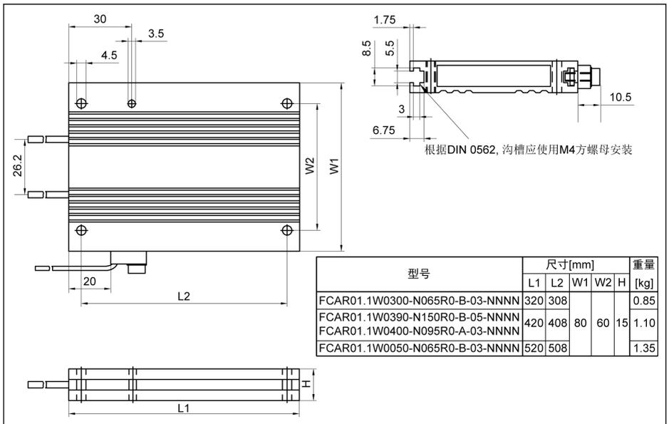
插图 14-35: 制动电阻尺寸\_2
