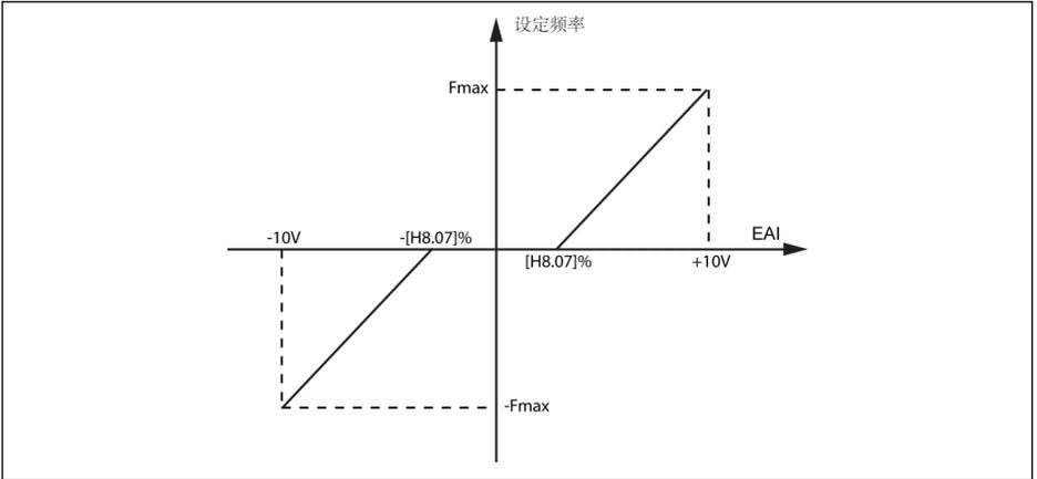
**插图 12-124:** 外部模拟输入的死区滤波
