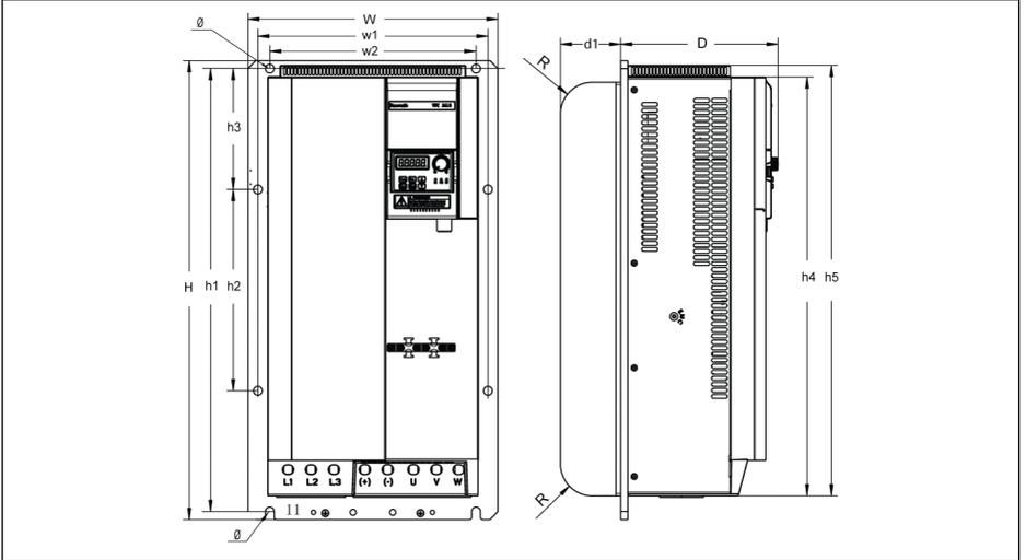
插图 7-11: VFC 5610 45K0...55K0 外型图(穿墙式机型)
