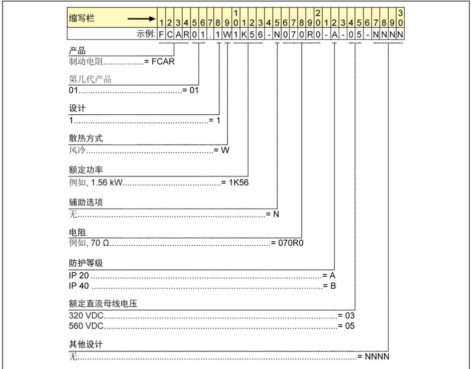
插图 18-10: 外置制动电阻类型编码
