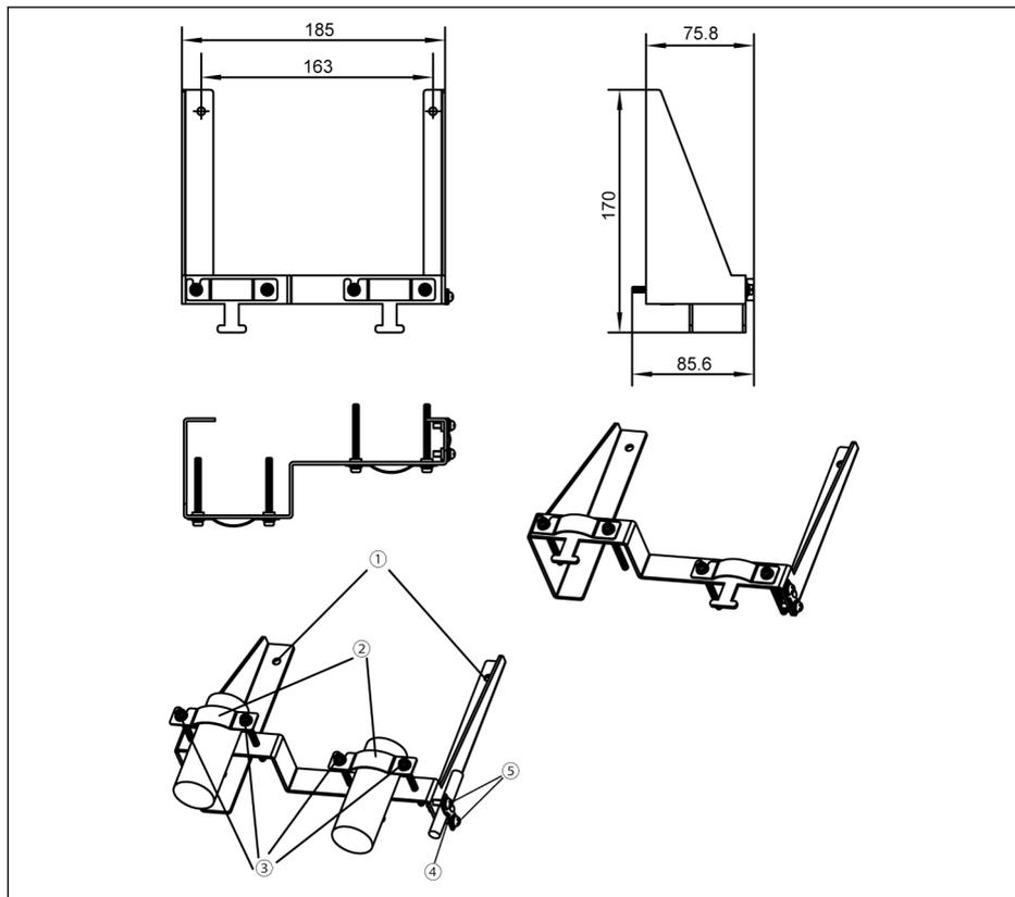
插图 14-41: 30K0...37K0 屏蔽电缆连接附件
