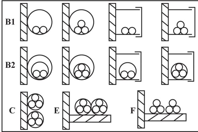
**B1** 导体在安装导管内或者可打开的电缆槽内
