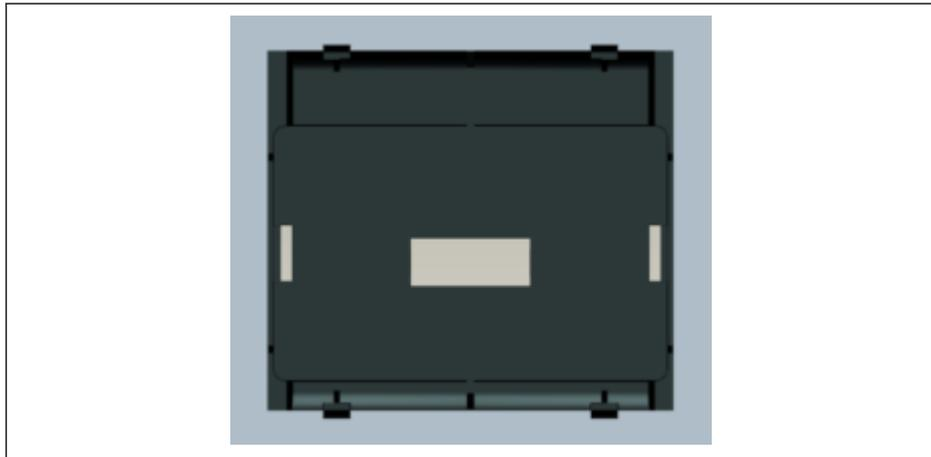
插图 14-2: 压入安装托盘(后视图)
