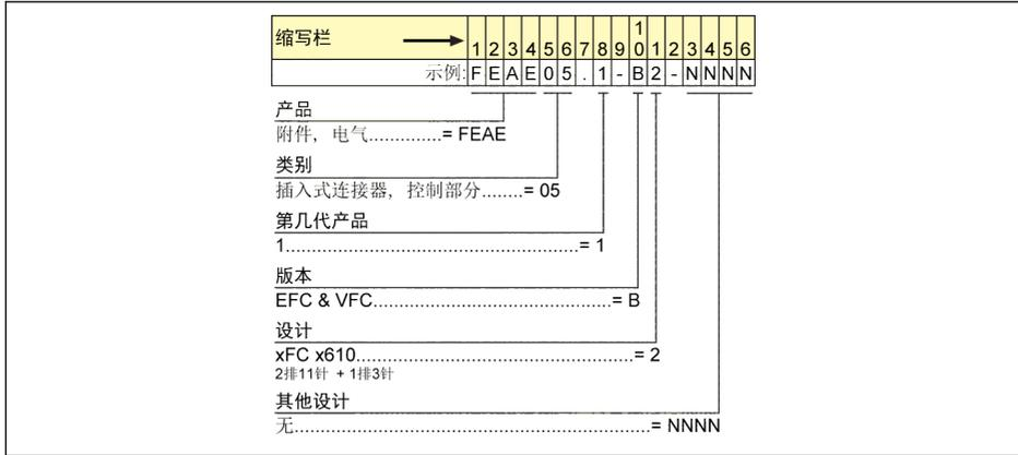
插图 18-8: 插入式控制端子连接器类型编码
