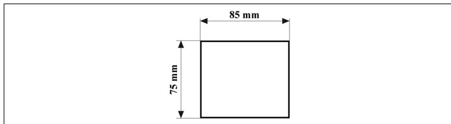
插图 14-1: 推荐控制柜开孔尺寸
