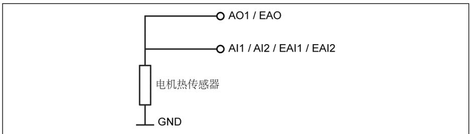
插图 12-29: 使用电流源的温度传感器
