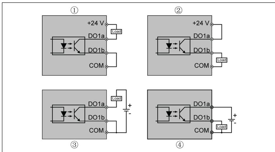
① 内部电源负载上拉接线方式
