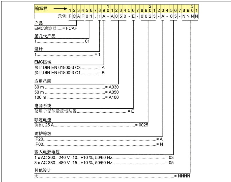
插图 18-9: 外置 EMC 滤波器类型编码
