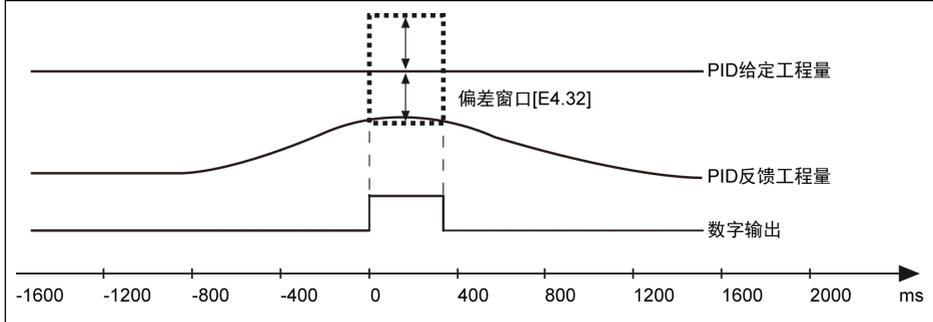
插图 12-103: PID 工程量检测宽度
