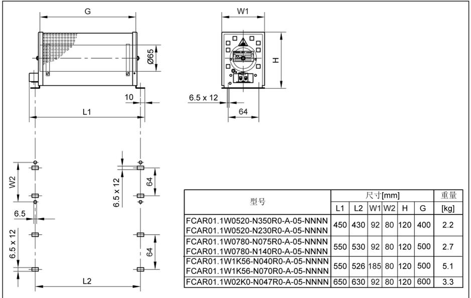
插图 14-34: 制动电阻尺寸\_1
