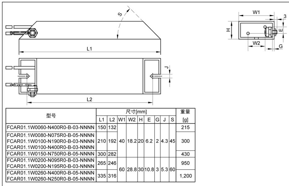
插图 14-36: 制动电阻尺寸\_3
