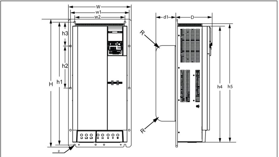
插图 7-12: VFC 5610 75K0 外型图(穿墙式机型)
