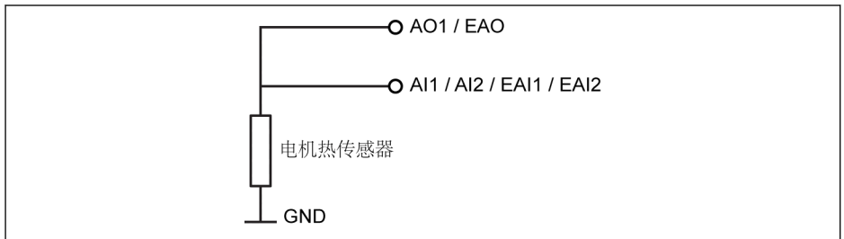
插图 12-49: 使用电流源的温度传感器
